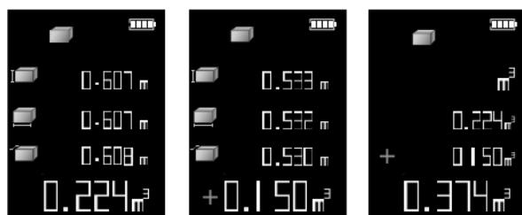
Вычислите первый объём. Нажмите кнопку и проведите измерение второго объёма. Повторяйте этот шаг столько раз, сколько необходимо, дальномер подсчитает сумму всех измеренных объёмов. Нажмите кнопку для вычисления суммы, которая отобразится в основной области дисплея. Вычитание производится аналогично сложению.
